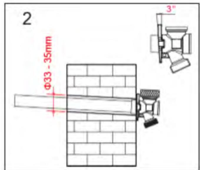
2. Смонтировать трубку (3) в ранее сделанное отверстие в стене. Излив с утолщенной площадкой позволяет сразу расположить кран с правильным уклоном  $3^\circ$ . Это поможет воде самой вытекать из трубки после закрытия крана.
