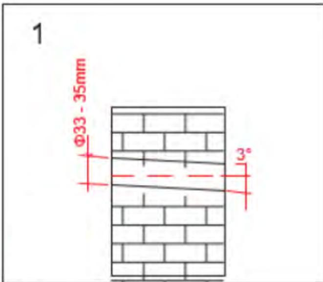
1. Просверлите в стене под трубку  $\Phi 22$  мм (для комфортного монтажа это будет  $\sim \Phi 33-35$  мм). Чтобы исключить риск замерзания, отверстие должно быть просверлено под углом примерно  $3^\circ$  вниз по направлению к внешней стороне здания.
