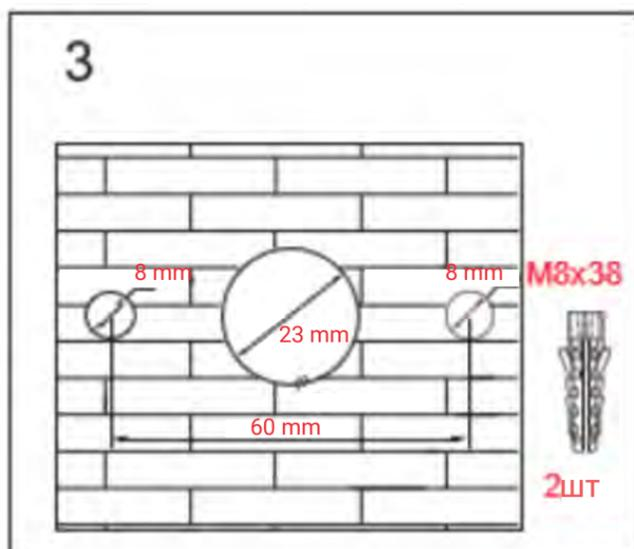
3. Просверлите в стене 2 монтажных отверстия диаметром 8 мм на расстоянии 60 мм. Установите пластиковые дюбели в отверстия.
